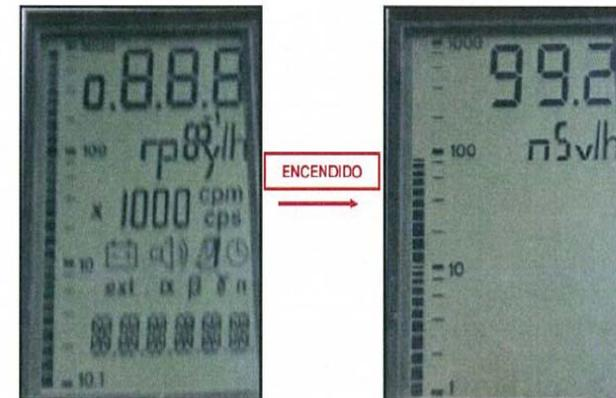
Si al encender el equipo se observara en la pantalla la señal
