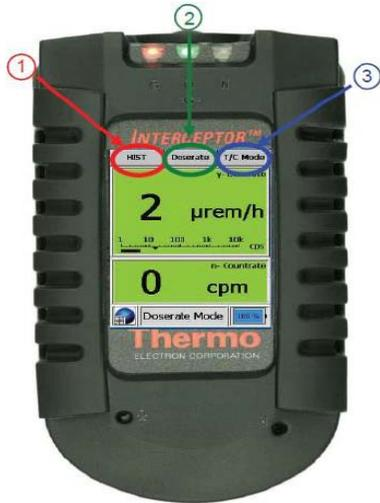
Monitor capaz de detectar radiación gamma y neutrones térmicos. Permite analizar cualitativamente una fuente de radiación gamma detectada mediante la identificación de los isótopos.
